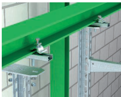
Zacisk stalowy z użyciem profilu C, równoległy przebieg trasy Montaż wieszaka U na wsporniku stalowym za pomocą profilu C CPS 4 G i lekkiego zacisku mocującego TKH-L-25. Przebieg trasy równoległy do konstrukcji stalowej.
