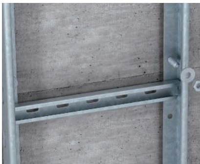
Bezpośredni montaż ścienny Bezpośrednie zamocowanie drabiny pionowej LG i SSL 45 za pomocą kotew śrubowych do ściany.
