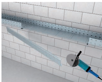
Wykonanie trójkąta z użyciem dołączanego elementu narożnego Usuwanie ścian bocznych koryta kablowego szerokorozpiętościowego
