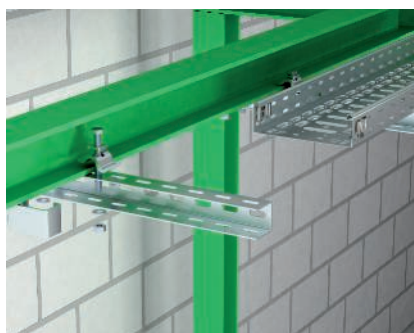
Wspornik do konstrukcji stalowej Za pomocą zacisków mocujących typ TKS-L-25 można mocować do konstrukcji stalowej profile US jako wsporniki. Dla bezpieczeństwa konstrukcji, należy zastosować elementy dystansowe typu DSK.
