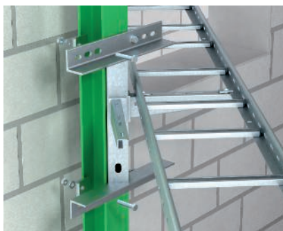
Płyta adaptera 45°, zaciski stalowe Montaż adaptera 45° typ KA-E 45 na konstrukcji stalowej za pomocą kątowników zaciskowych lub zacisków mocujących. W celu dodatkowego podparcia trasy w narożnikach i kątach pomieszczenia.
