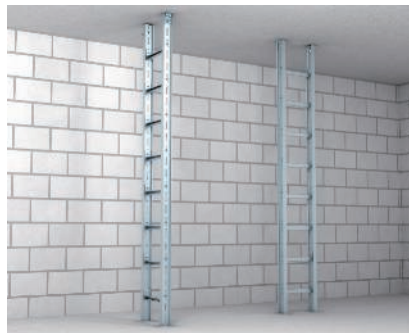
Montaż drabiny pionowej wolnostojącej Montaż wolnostojącej drabiny kablowych w pomieszczeniu za pomocą kątowników mocujących typ BW lub płyt głowicowych typ KUS 5 (do drabin pionowych ciężkich typ SLM 50) lub KI 8 (do drabin pionowych przemysłowych typ SLS 80).
