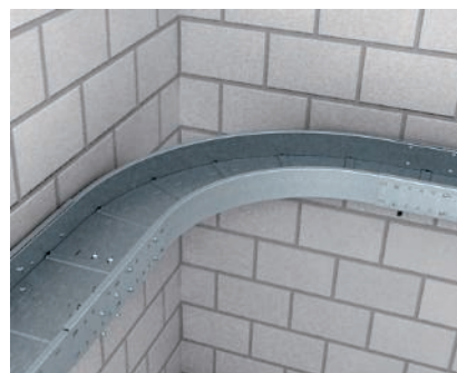
Montaż łuku 90° Łuk połączony z szerokorozpiętościowymi korytami kablowymi. Łuk jest połączony za pomocą łączników zewnętrznych i listwy stykowej z szerokorozpiętościowym korytem kablowym.
